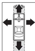
Kui liigute mõõteseadmaga üle metallobjekti esimest korda, lokaliseeritakse metallobjekti asend vaid ligikaudselt. Kui liigute mõõteseadmaga üle metallobjekti mitu korda, tuvastab seade objekti asukohta üha täpselt. Pärast mitmekordset üleliikumist (mõõteseadet pinnalt tõstmata) saab metallobjekti asendit kuva da täpselt: kui süttib punane signaaltuli **2** ja kõlab helisignal, asub sensori piirkonnas metallobjekt. Kui helisignal on kõige kõrgem, on metallobjekt sensori keskpunkti all.
