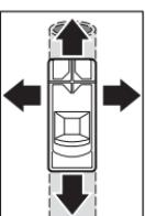
Бірінші өткізуде метал заттың орналасқан жері шамамен көрсетіледі. Егер метал заты үстінен өлшеу құралын бірнеше рет өткізе, затты нақты анықтауға болады. Бірнеше рет өткізуден соң (өлшеу құралын табандан көтермей) метал заттың орналасқан жері анық көрсетіледі: қызыл сигнал шамы **2** жаңып, сигнал дыбысы шықса, метал заттың сенсор аймағының астында жатқаны.
