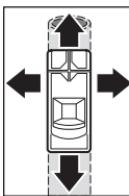
Při prvním přejetí je indikována poloha kovového předmětu pouze přibližně. Pokud přejedete měřicím přístrojem nad kovovým předmětem několikrát, bude se přesnost jeho detekce zvyšovat. Po několikátém přejetí (anž byste zvedali měřící přístroj z podkladu) můžete polohu kovového předmětu určit přesně: Svítí-li indikační kontrolka **2** červeně a zní-li zvukový signál, leží kovový předmět pod oblastí čídla. Když je výška zvukového signálu maximální, nachází se kovový předmět pod středem čídla.
